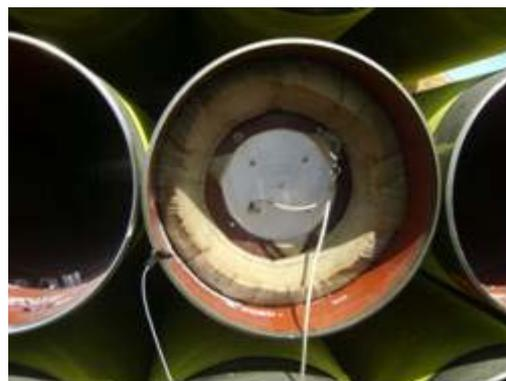
Figura 14 – Inspeção de descontinuidade
