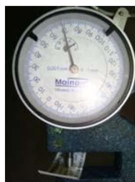
Figura 4 – Valor de rugosidade (micrômetro)
