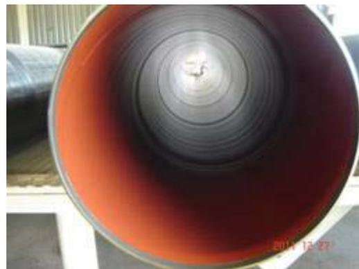
Figura 8 –Tubo revestido após cura total
