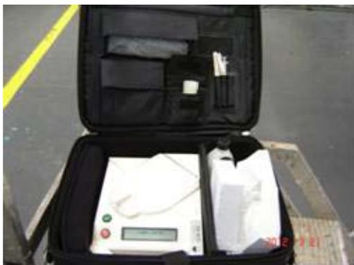
Figura 1 – Equipamento para medição de sais solúveis
