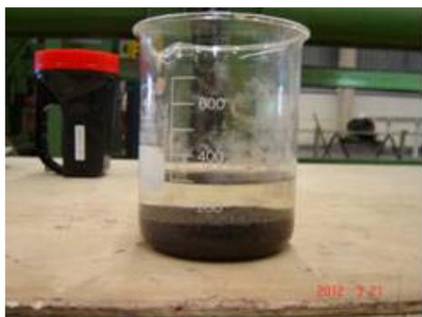
Figura 5 – Contaminação da granalha.
