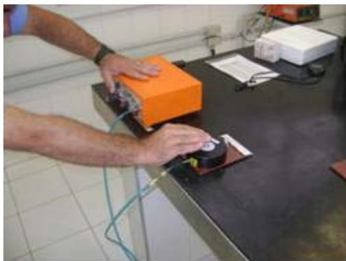
Figura 17 – Ensaio de aderência *pull-off*
