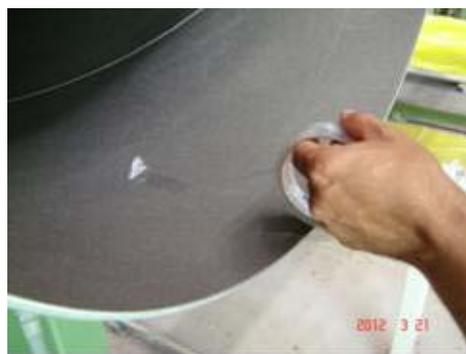
Figura 6 – Contaminação por pó.
