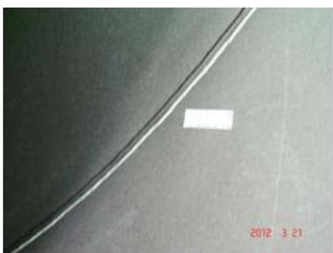
Figura 3 – Medição de rugosidade (“replica-tape”)
