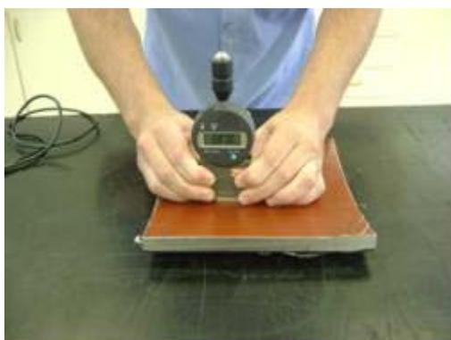
Figura 18 – Ensaio de Dureza
