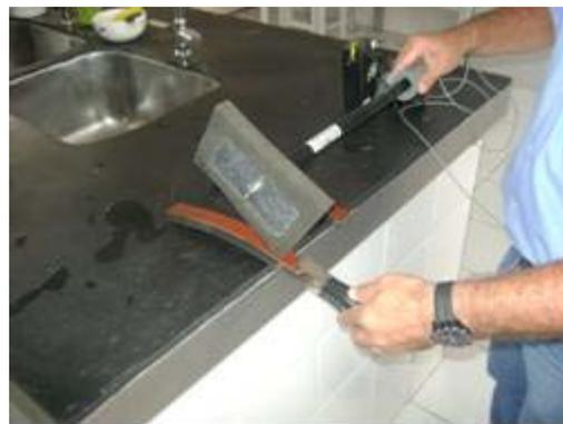
Figura 16 – Verificação de trincas
