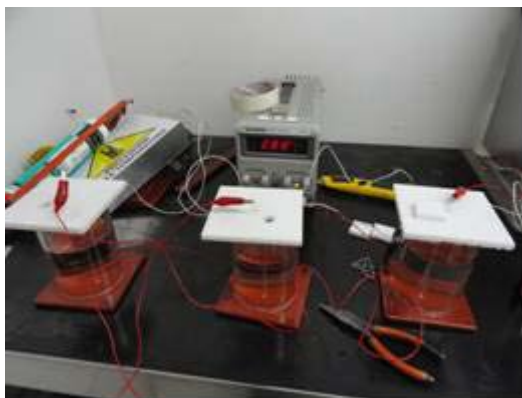
Figura 24 – Ensaio descolamento catódico (DC)
