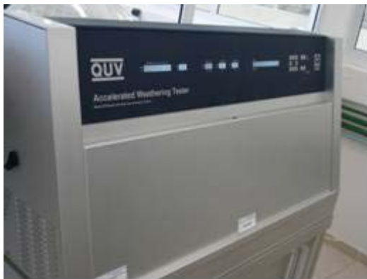
Figura 30 – Ensaio de envelhecimento UV
