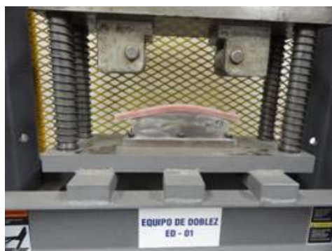
Figura 14 – Ensaio de Dobramento a -30 °C
