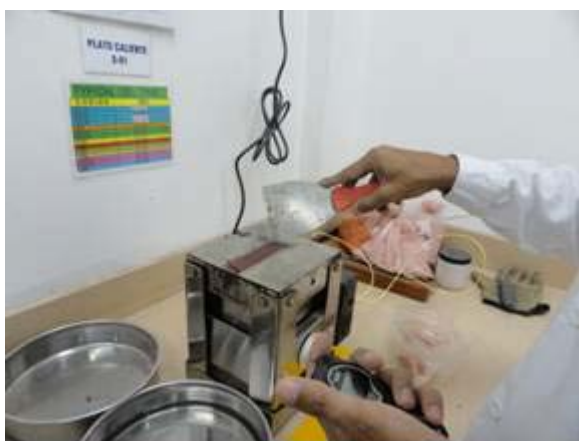
Figura 7 – Tempo de gel do epóxi
