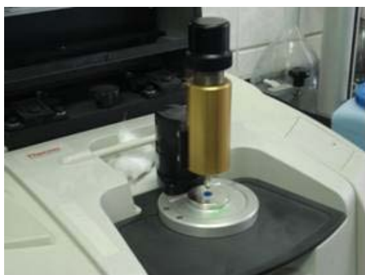
Figura 16 – Espectômetro de Infravermelho
