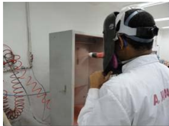
Figura 2 – Aplicação do revestimento
