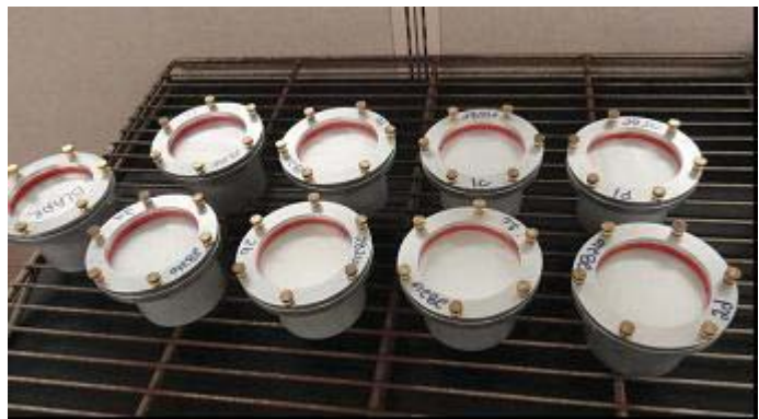
Figura 36 – Ensaio de Transmissão de vapor
