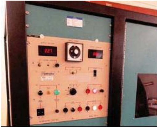
Figura 22 – Equipamento ensaio de rigidez dielétrica
