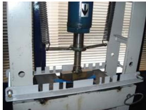
Figura 15 – Ensaio de Dobramento
