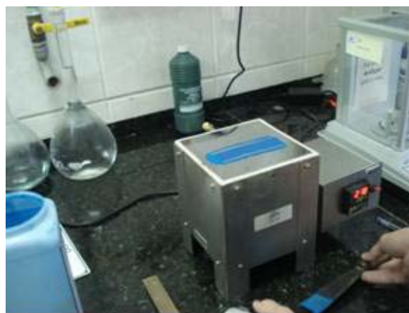
Figura 8 – Superfície à 205^{\circ}\text{C} \pm 3^{\circ}\text{C}
