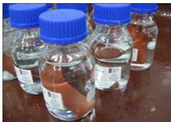
Figura 21 – Ensaio Absorção de água
