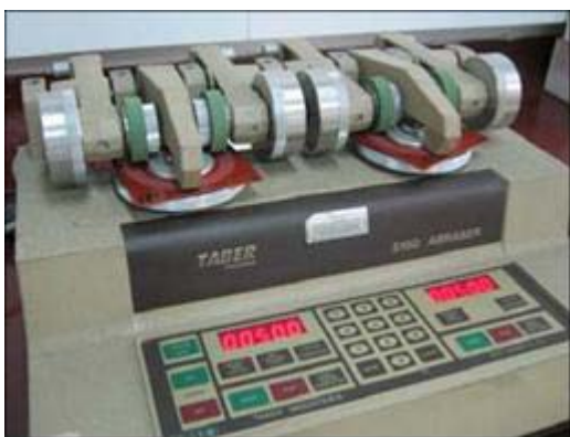
Figura 26 – Ensaio de Abrasão
