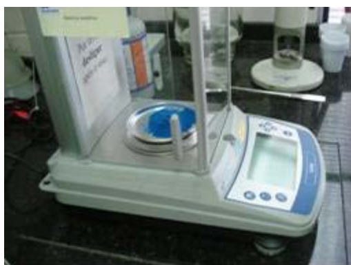
Figura 12 – Pesagem da amostra
