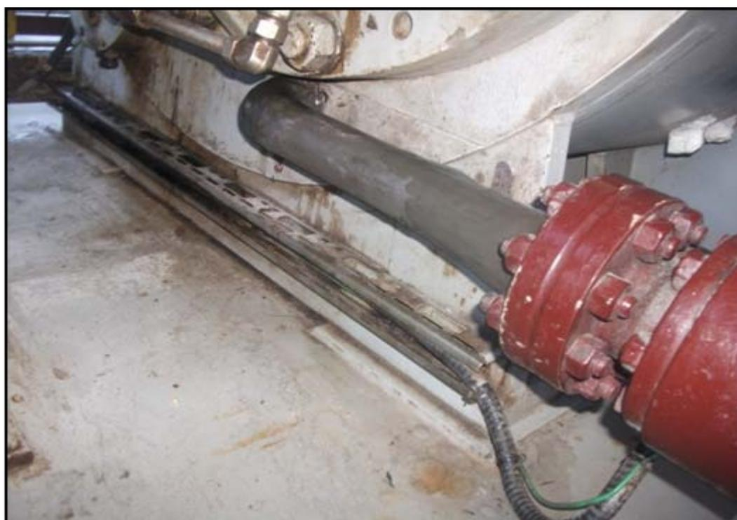
Figura 2 - Aplicação de resina para recompor a geometria do substrato
