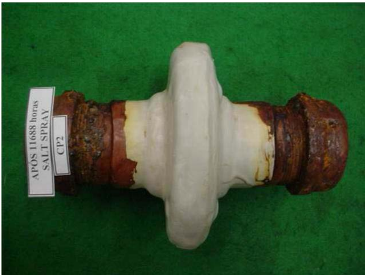
Figura 1 – aspecto geral do flange revestido, após o período decorrido do teste no CENPES
