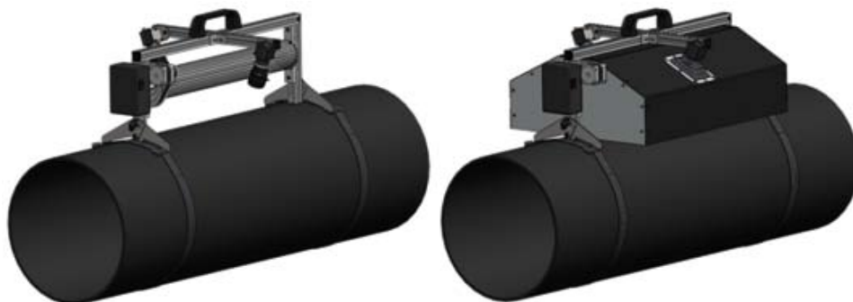
Figura 12 - À esquerda, representação do protótipo sem a cobertura. À direita, o protótipo com a cobertura externa.
