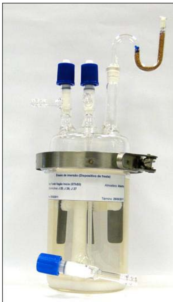
Figura 2 – Recipiente de ensaio com tubo em S para os meios em contato com o ar atmosférico
