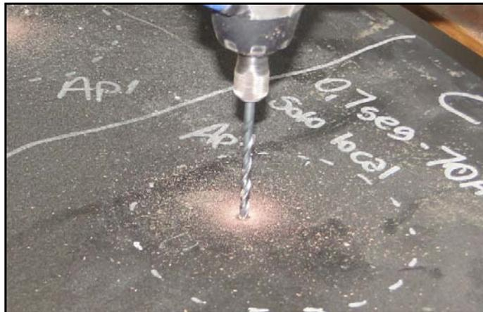
**Figura 3 – Execução de um defeito no revestimento sendo realizado com auxílio de broca e furadeira.**
