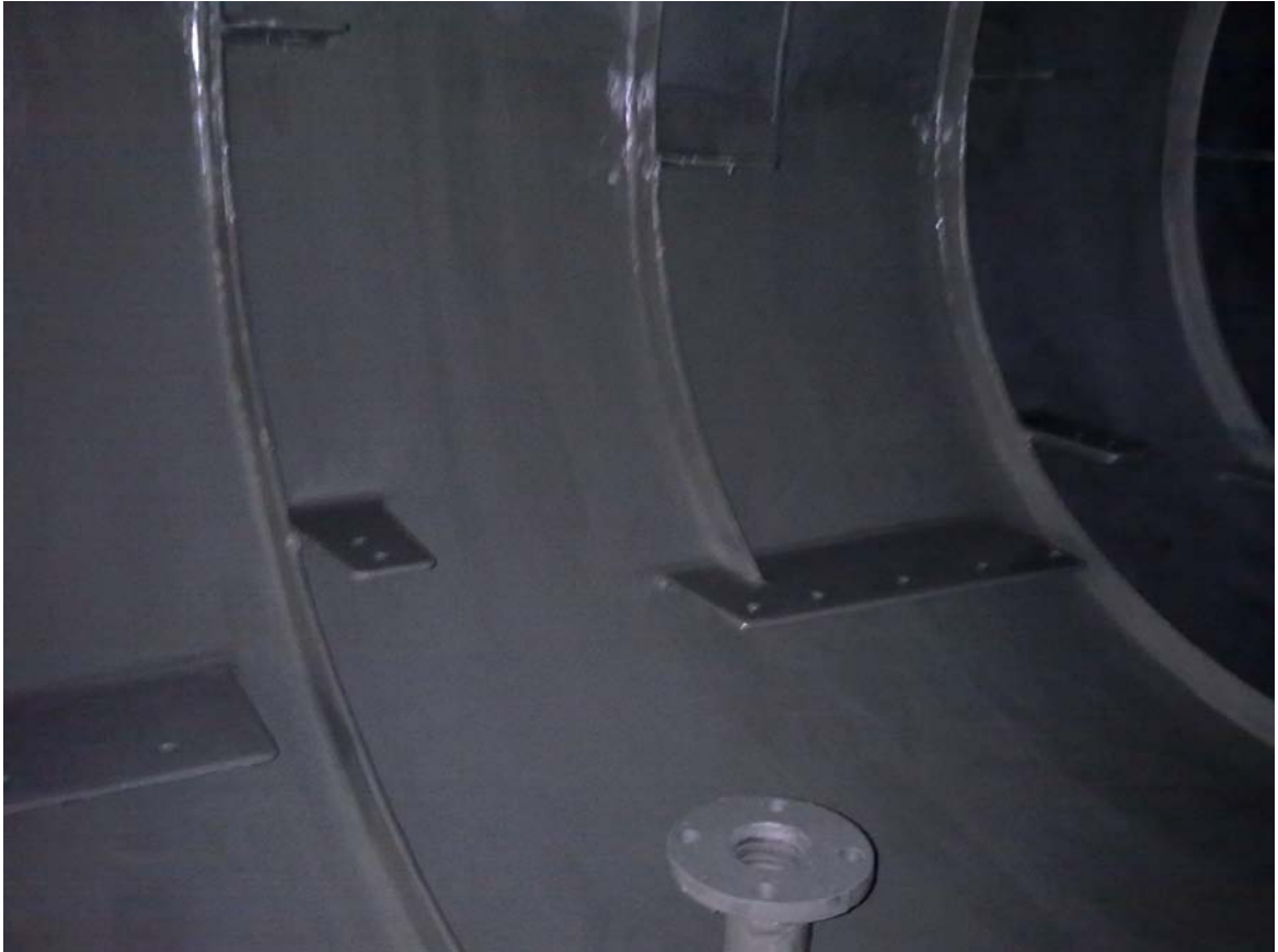
Figura 7: Polímero totalmente aplicado, pronto para receber a curva de aquecimento.
