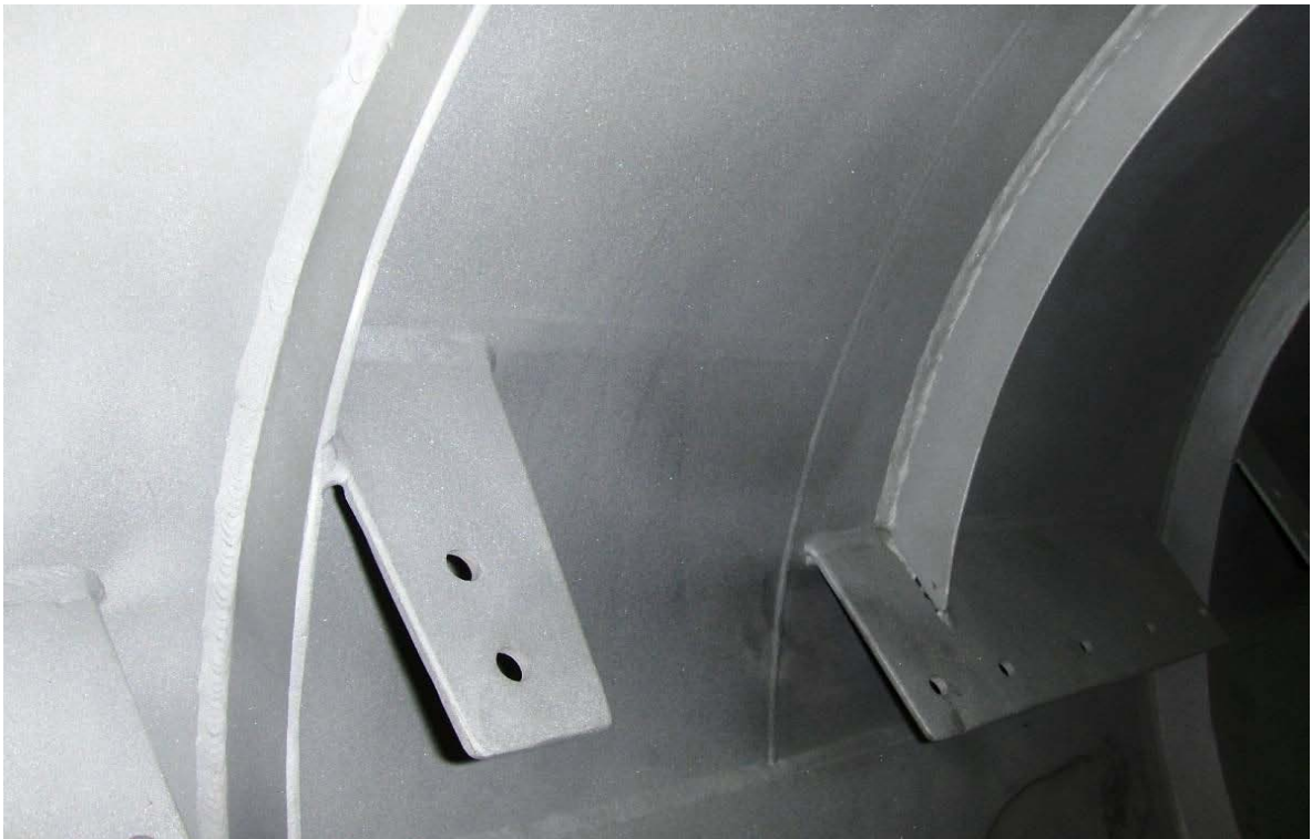
Figura 2: Tratamento mecânico com adoçamento e quebra de quinas dos suportes internos das bandejas
