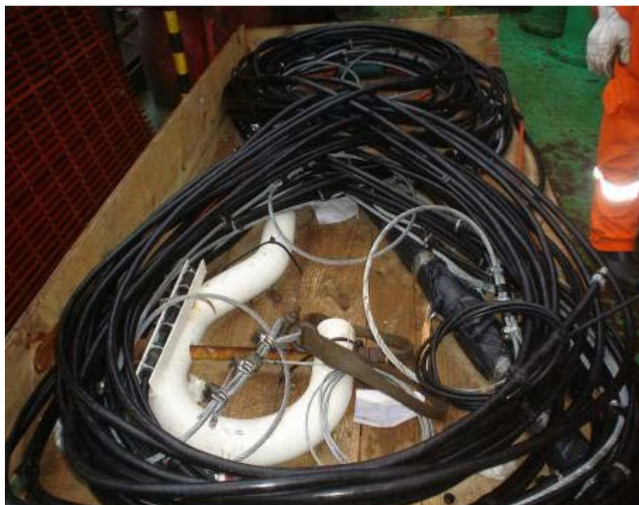
Foto 1 – Plataforma P-20 / Detalhe do conjunto anodo/ER Zn já inspecionado pronto para instalação
