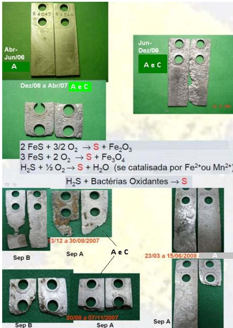
Figura 7– Fotos dos cupons em aço carbono instalados no sistema de tratamento de água oleosa da plataforma A e reações possíveis de geração de enxofre elementar.
