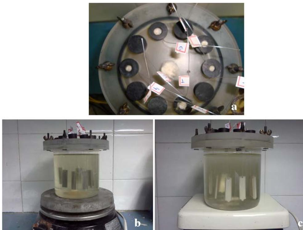
**Figura 1:** Sistema utilizado no monitoramento da formação de biofilme e biocorrosão [vista superior (a); e vista frontal, apresentando CPS sem revestimento (b) e com revestimento (c)].
