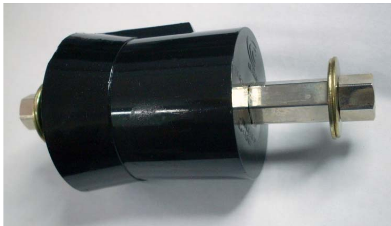
Figura 8 - Dispositivo de proteção contra surtos, baseado no uso de centelhador a gás, utilizado nos testes (fonte: Clamper - 2011).
