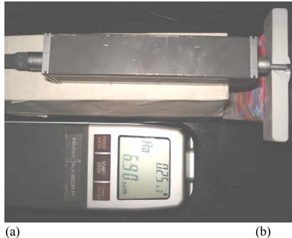
Figura 4. Detalhamento do método de ensaio acelerado de corrosão adota no experimento. Em (a) bancada experimental para ensaio acelerado de corrosão por imersão e (b) apresentação da forma de medição da evolução da rugosidade superficial via rugosímetro portátil (Barra e Rezende, 2009; Barra et al., 2008).
