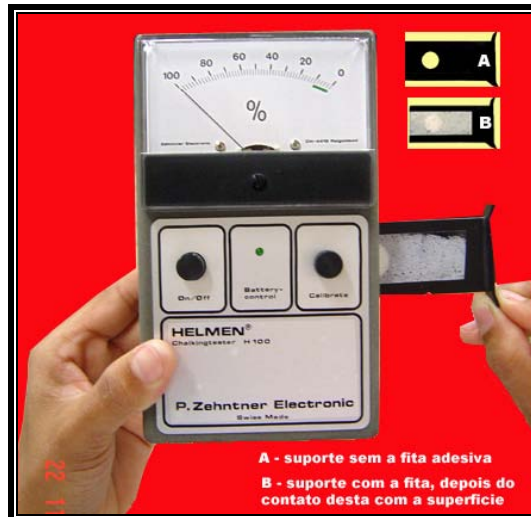
Figura 2 – Equipamento utilizado na avaliação do empouamento pelo método Helmen ®
