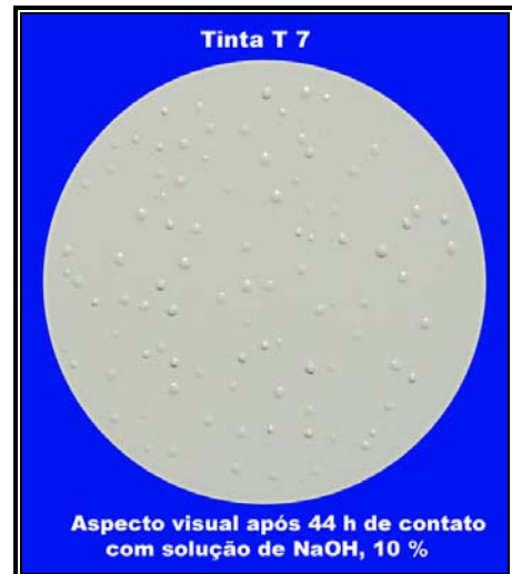
Figura 7 – Aspecto da película da tinta T7, após 44 horas de contato com solução de NaOH, 10%
