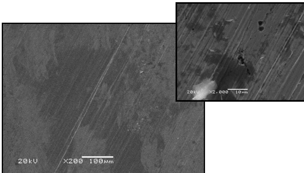
Figura 8 - Micrografia obtida no MEV para o aço A 285 após ensaio eletroquímico com o LI 2HEAA.
