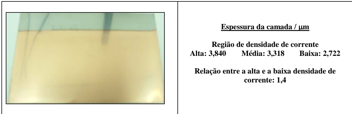
Figura 4 - Painel de aço-carbono AISI 1010 após eletrodeposição do cobre na presença de aditivos empregando célula de Hull. Composição do banho: 80 g/L de \text{CuSO}_4 \cdot 5\text{H}_2\text{O} , 160 g/L de NaOH, complexante e os parâmetros empregados foram: 60 °C, 10 min e sem agitação.
