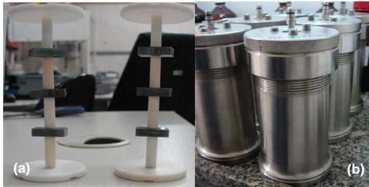
Figura 1 - Montagem dos experimentos. (a) Corpos de prova na base de Teflon. (b) Autoclaves utilizadas nos ensaios.
