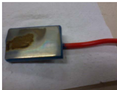
Figura 14 – Corpo-de-prova de aço-carbono, após ensaio de acompanhamento do potencial em água com inibidor .
