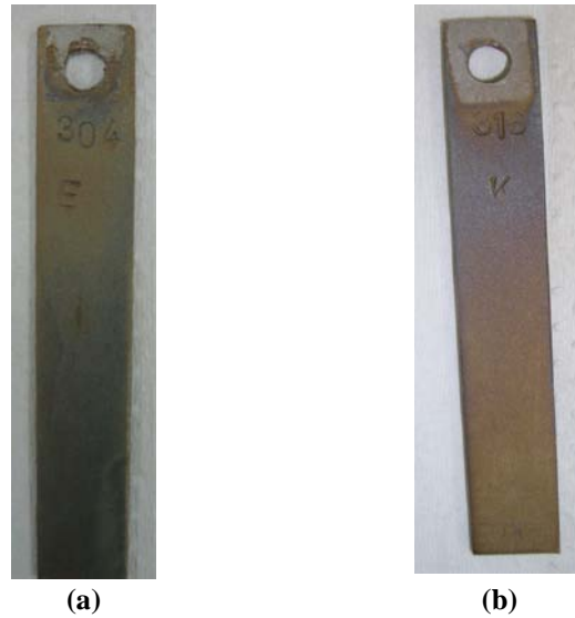
Figura 7 – Aspecto visual dos corpos-de-prova de aço inoxidável após exposição por 54 dias sem inibidor: (a) 304; (b) 316.
