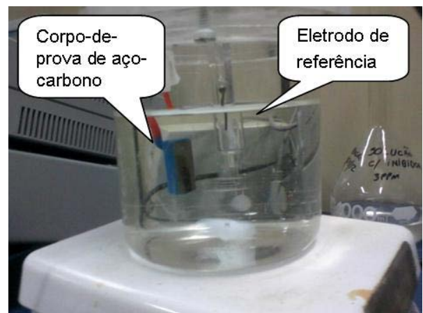
Figura 12 – Detalhe do procedimento de medida do potencial.
