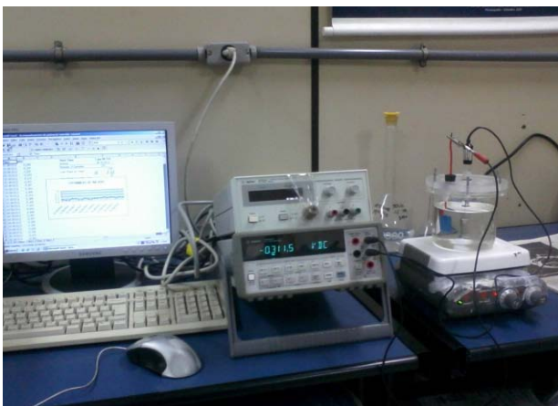
Figura 11 – Equipamento para medição do potencial eletroquímico.
