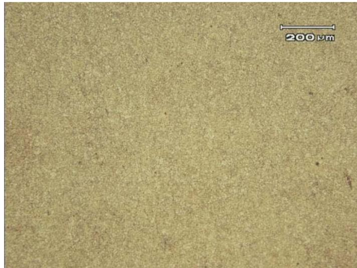
**Figura 10 – Micrografia do metal estudado. Aumento 100x. Reagente NITAL 2%.**
