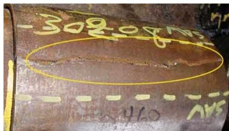
**Figura 2 - Fratura causada por SSC em uma conexão de aço API exposto a ambiente contendo baixo e médio teor de  $H_2S$  submetido a altas tensões internas (6).**
