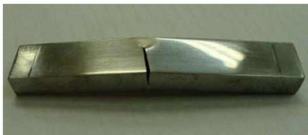
**Figura 12 – Perfil das fraturas encontradas nos corpos de prova ensaiados em fadiga ao ar do aço API 5CT P110.**
