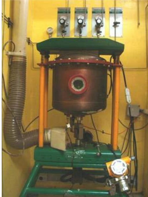
**Figura 8 – Equipamento desenvolvido no grupo GECOR utilizado para ensaios de corrosão-fadiga.**
