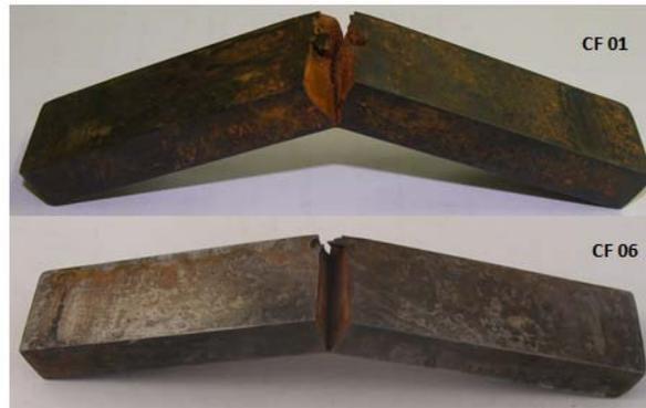
**Figura 16 – Perfil das fraturas encontradas nos corpos de prova ensaiados em corrosão-fadiga do aço API 5CT P110 dos corpos de prova CF 01 e CF 06.**
