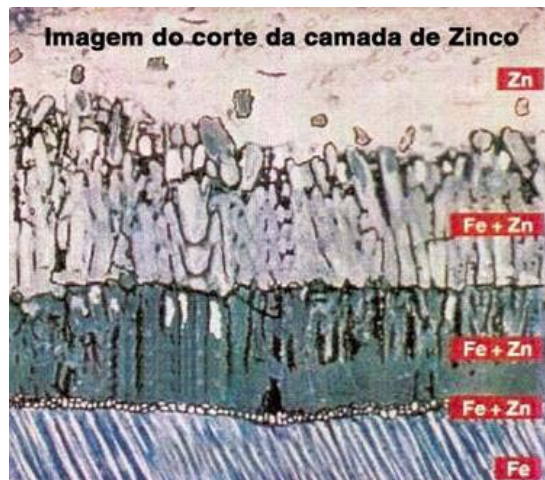
Figura 6 – Esquema típico de um revestimento galvanizado por imersão a quente (3)
