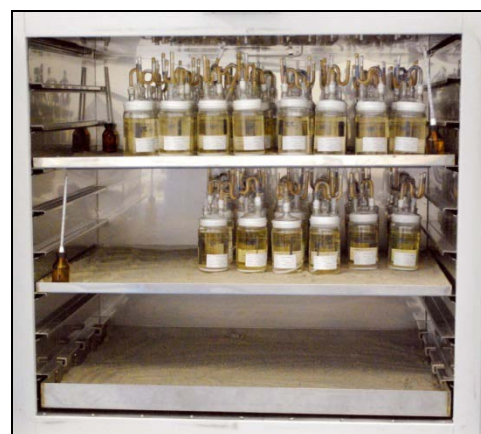
Figura 3 – Arranjo experimental dos ensaios de imersão a temperaturas acima do ambiente.
