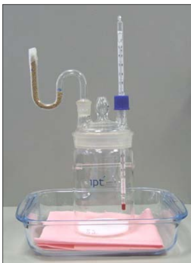
Figura 2 – Arranjo experimental dos ensaios de imersão a temperatura ambiente.
