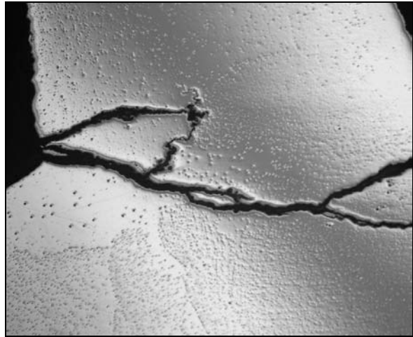
Figura 12 – Seção transversal ao cordão de solda. Trinca ramificada nucleada na superfície interna. Sem ataque - Aumento original: 105 x.
