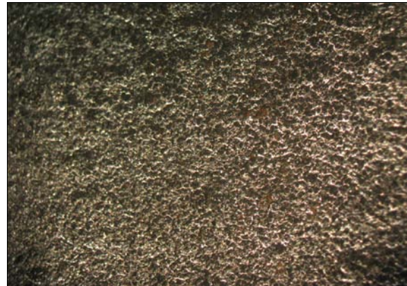
Figura 04 – Superfície interna da tubulação. Corrosão alveolar generalizada. Ampliação por meio de lupa estereoscópica.
