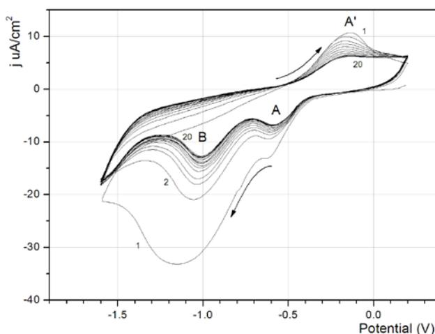
**Figura 3** – Curva ciclovoltagem de nitrato de urânio (solução aquosa de 2 x 10<sup>-3</sup> mol.L<sup>-1</sup>) com velocidade de varredura de 0,05 V/s. O eletrodo de referência utilizado foi de Ag
