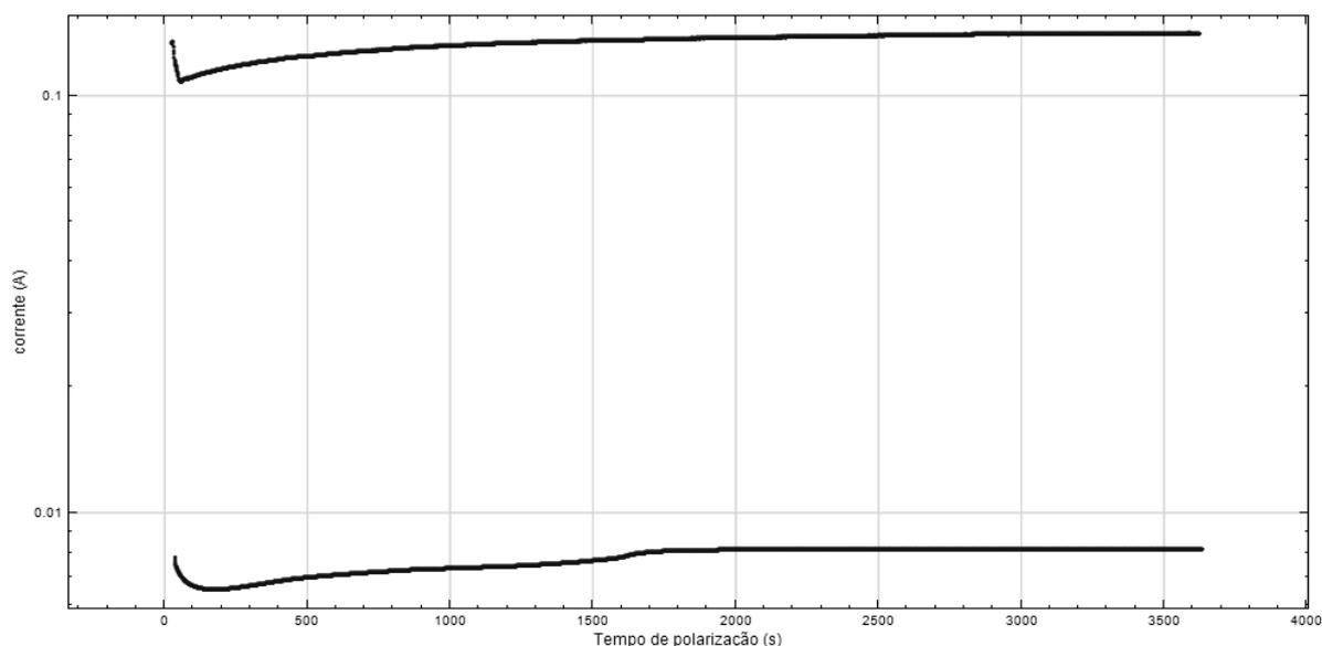
**Figura 4 – Curvas de eletrodeposição de nitrato de uranila ( $0,05 \text{ mol.L}^{-1}$  de U) durante  $3600 \text{ s}$  com polarização catódica: (curva superior)  $P = -30\text{V}$  e (curva inferior)  $P = -3\text{V}$  sobre uma área de  $2,6412 \text{ cm}^2$**
