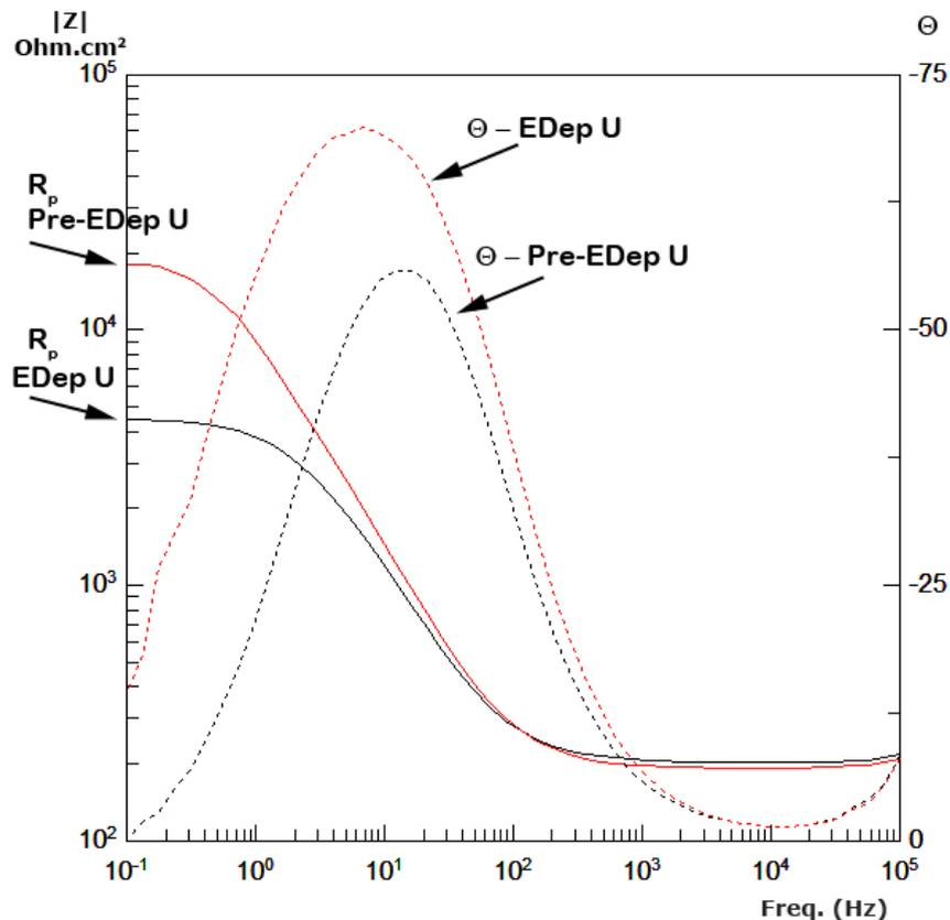
Figura 5 – Diagrama de Bode de impedância eletroquímica mostrando o efeito cumulativo do depósito eletroquímico de urânio (8 pontos adquiridos por década)
