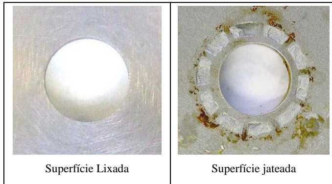
Figura 1 – Detalhe da região dos corpos de prova do aço inoxidável superdúplex SAF 2507 onde os dispositivos formadores de frestas estiveram instalados. Condição de ensaio: imersão total nas águas rasas do canal de São Sebastião, litoral de São Paulo, após 150 dias (10).
