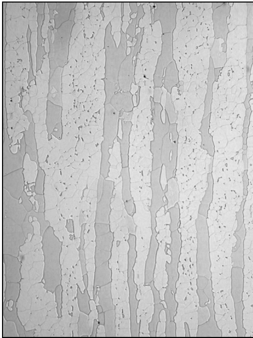
Figura 5 – Micrografia do aço inoxidável superdúplex SAF 2507 solubilizado. Ataque eletrolítico: ácido oxálico 10 %, 10 V, 60 s. Microestrutura formada por grãos de ferrita (cor escura) e de austenita (cor clara).
