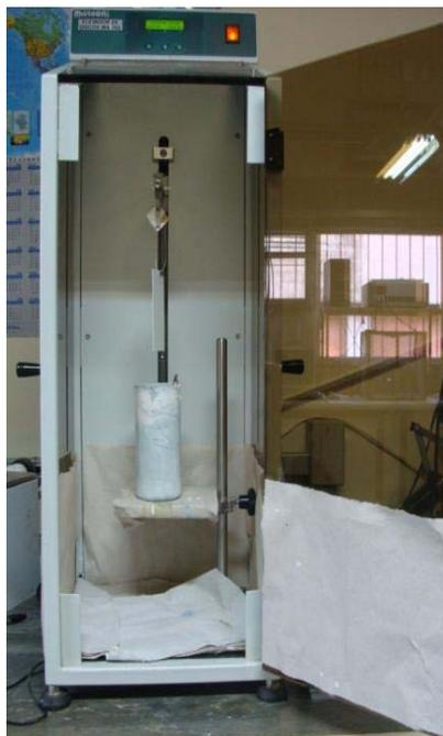
Figura 3 - Equipamento *Deep Coating Elevador de Disco MA 765-Marconi*, empregado na aplicação de revestimentos.
