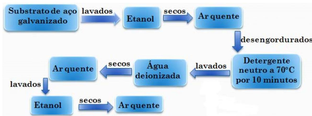
Figura 1 - Fluxograma de preparação da superfície.
