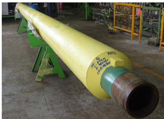
Figura 1 – Tubo com revestimento anticorrosivo e GSPU aplicado.
