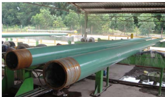
Figura 2 – Tubo com o revestimento de FBE aplicado.
