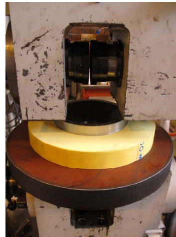
Figura 13 – Apparatus utilizado para o teste de resistência ao cisalhamento.
