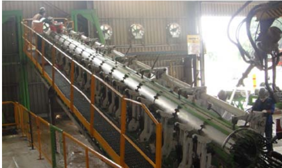
Figura 4 – Tubo na forma pronto para receber GSPU.
