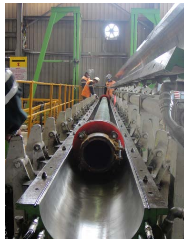
Figura 3 – Tubo posicionado na forma.
