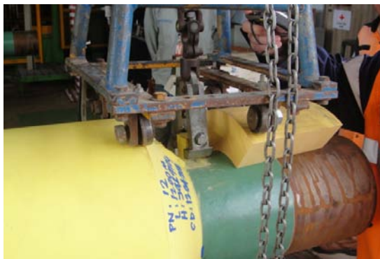
Figura 6 – GSPU aplicado no tubo sendo submetido a teste de aderência.
