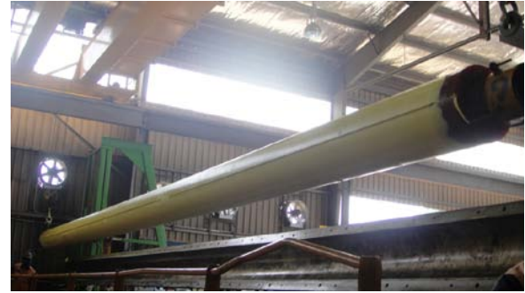
Figura 5 – Tubo com GSPU sendo retirado da forma.
