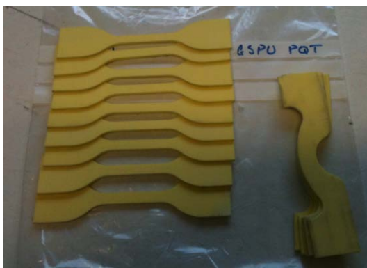
Figura 8 – Corpos de prova para execução dos testes de ruptura, alongamento e nicked crescent tear strength .
