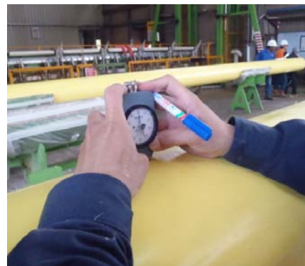
Figura 7 – Medição da dureza do GSPU aplicado ao tubo.
