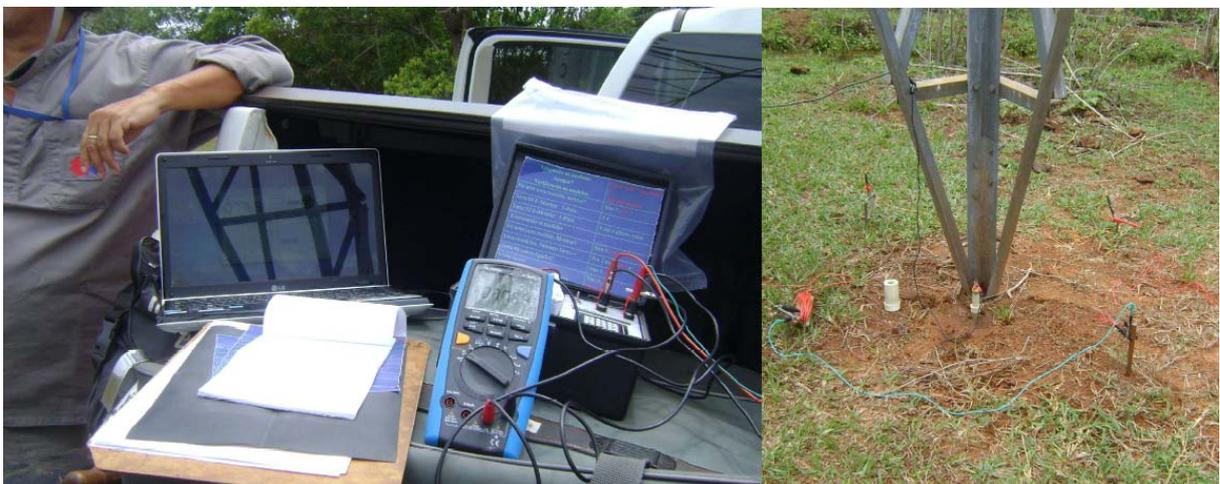
**Figura 1: Aplicação da técnica injeção de corrente em uma torre de linha de transmissão.**
