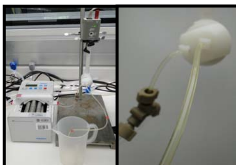
Figuras 5 e 6 - Sistema misturador conectado à bomba peristáltica e a célula de fluxo utilizado no Ensaio I.
