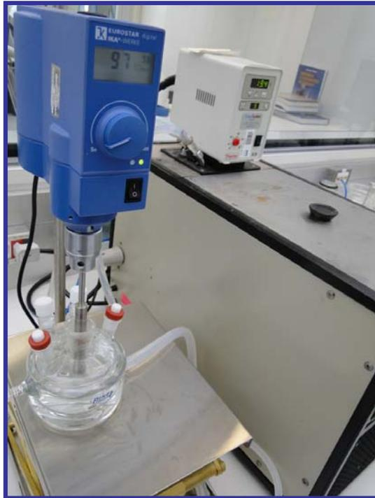
**Figura 2 - Aparato utilizado no procedimento de avaliação da adesão de incrustações salinas – corpo de prova rotatório.**
