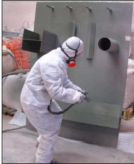
Figura 2. Aplicación de pintura sobre panel de examen.
