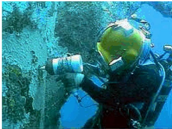
**Figura 9 – Medição de potencial com utilização do bathycorrometer**
