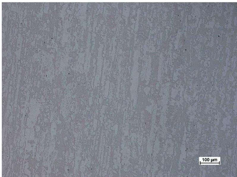
**Figura 10 – Metalografia da amostra envelhecida a 475°C por 12 h.
