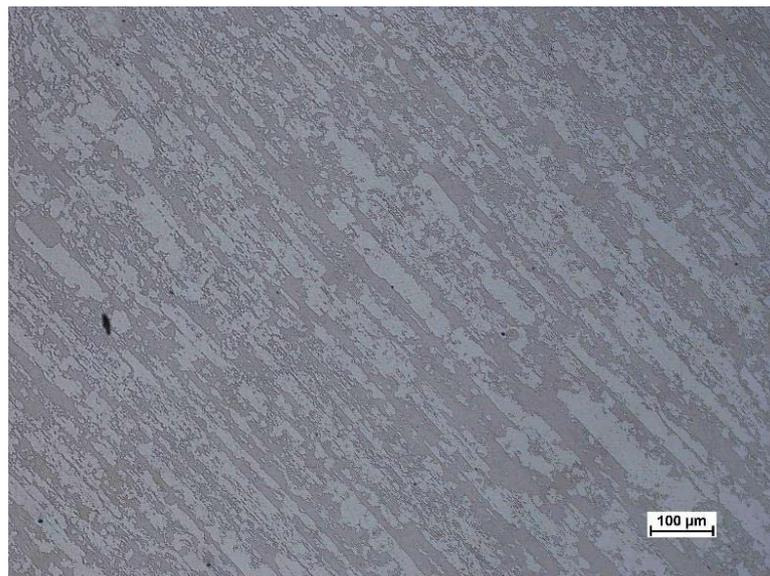
**Figura 8 – Metalografia da amostra envelhecida a 475°C por 4 h. Ataque: Behara, 60°C, durante 20 s**
