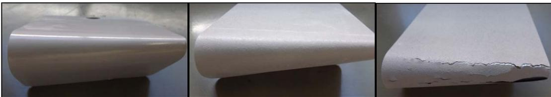
**Figura 1- Aspecto dos painéis pintados com tinta líquida após o ensaio de flexibilidade:**
