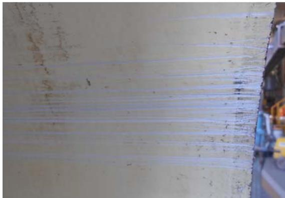
Figura 8 – Marcas ou sulcos devido à passagem de *pig* raspador com escovas de aço.
