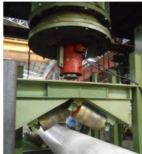
Figura 5 – Apparatus para o teste *stinger roller*.
