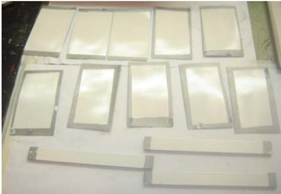
Figura 4 – Painéis aplicados aguardando cura para a realização de testes de controle de qualidade.
