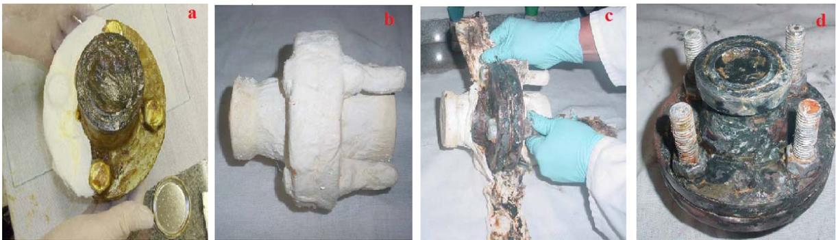
**Figura 14 – (a) aplicação do primer (marrom) e da fita anticorrosiva (branca), (b) após ensaio, (c) processo de remoção do produto e (d) aspecto do corpo de prova após a remoção do produto.**
