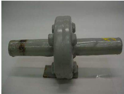
Figura 4 - Revestimento elastomérico em regiões críticas.
