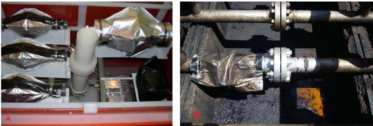
**Figura 10 – (a) câmaras de ensaio de umidade e temperatura com acelerada corrosão e (b) uniões flangeadas após o ensaio.**
