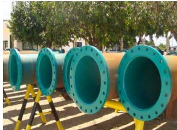
Foto 30 – Uso de revestimentos internos em tubulações de processo
