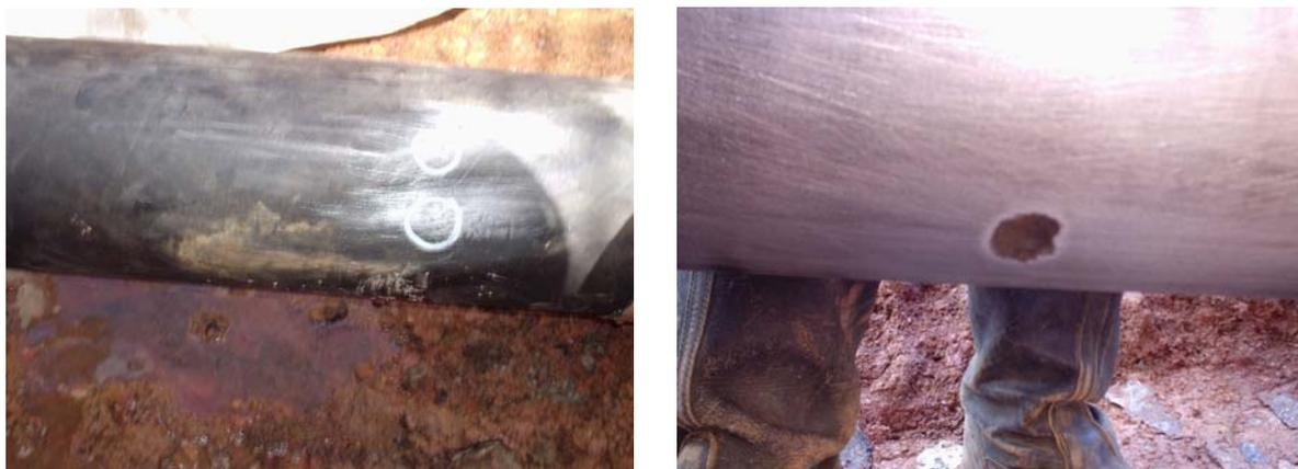
**Figura 8 - Registro de corrosão AC no local indicado nos gráficos**
