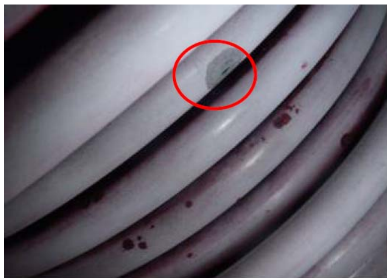
Figura 7 – Detalhe do feixe tubular com indicações no ensaio de LP – presença de pites na região inferior (fev/2012) (2) .
