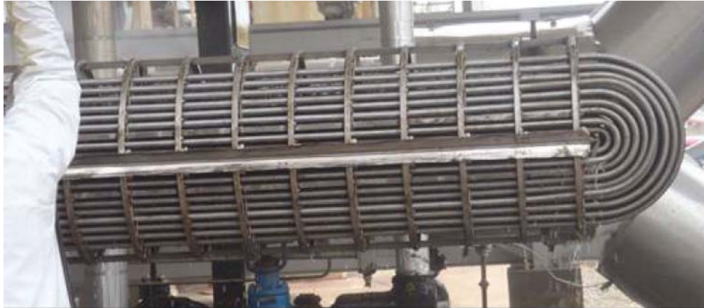
Figura 4 – Feixe tubular sem presença de danos externos após limpeza (2) .
