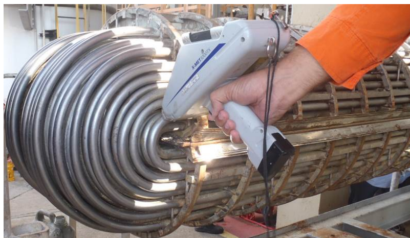
Figura 9 – Identificação positiva de Materiais com analisador de ligas portátil EDX (2) .
