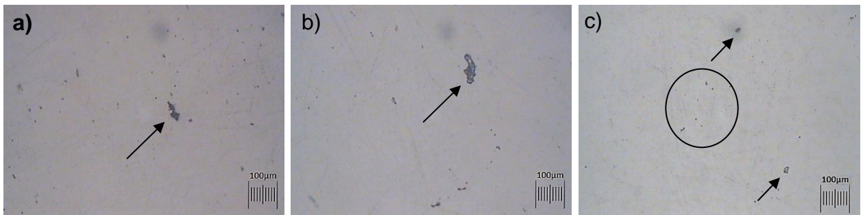
Figura 2 – Aspecto microscópico após polimento dos cupons produzidos pelos fornecedores A (a); B(b) e C(c). Microscopia ótica, aumento 500X.
