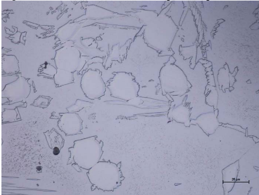
Figura 1 - Micrografia da amostra A1 atacada com oxálico 10% 3V 180s
