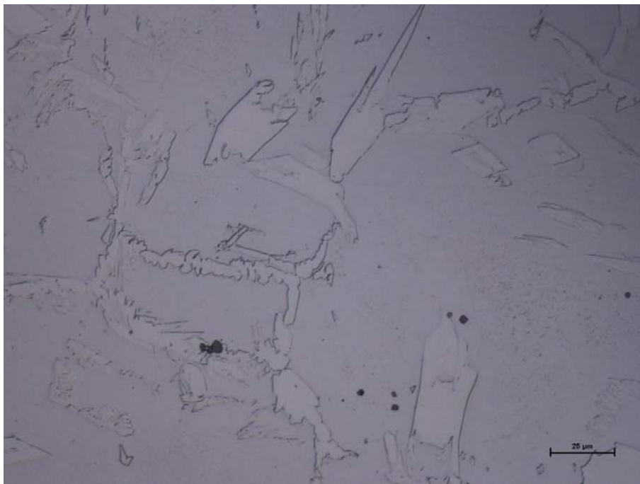
Figura 2 - Micrografia da amostra O1 atacada com oxálico 10% 3V 180s
