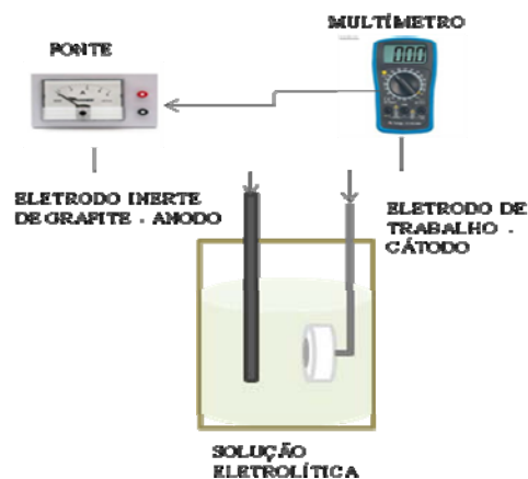
Figura 3 - Representação da célula eletrolítica.
