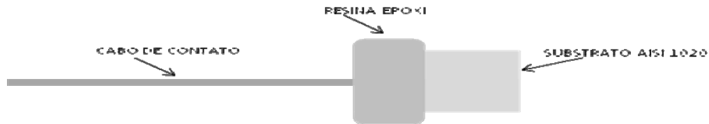
Figura 2 - Esquema do eletrodo de trabalho utilizado no ensaio para avaliar a resistência à corrosão
