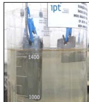
Par bimetálico aço-carbono/aço-carbono revestido com zinco
