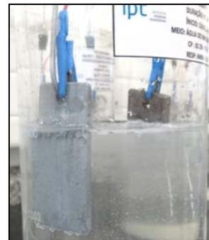
Par bimetálico aço-carbono/aço-carbono revestido com zinco
