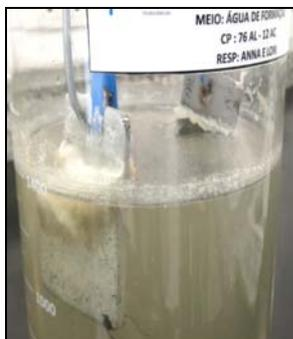
Par bimetálico aço-carbono/aço-carbono revestido com alumínio
