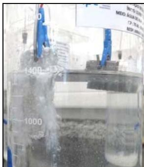
Par bimetálico aço-carbono/aço-carbono revestido com alumínio
