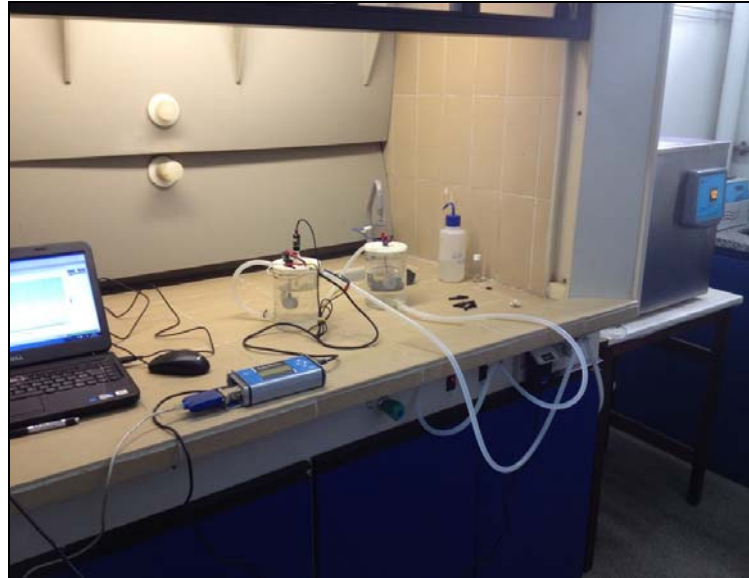
Figura 1 – Potenciostato, célula de corrosão e banho termostático utilizados para realização dos ensaios eletroquímicos
