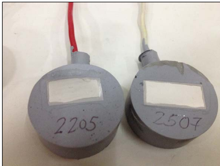
Figura 16 - UNS 32205 e UNS 32750 – Não foram observados pites de corrosão
