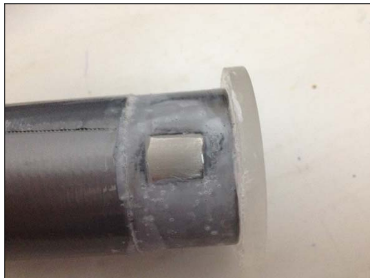
Figura 14 - AISI 444 - Não foram observados pites de corrosão
