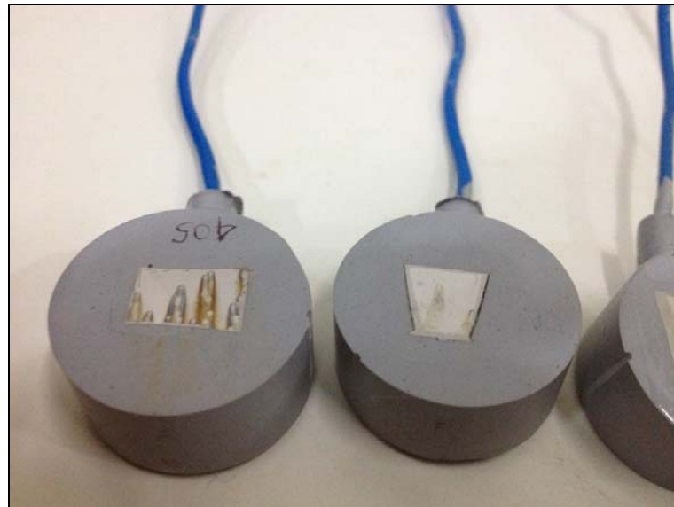
Figura 13 – Aços AISI 405 e AISI 430 – Foram observados pites de corrosão
