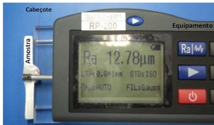
Figura 3 - Apresentação da forma de medição da rugosidade superficial via rugosímetro portátil
