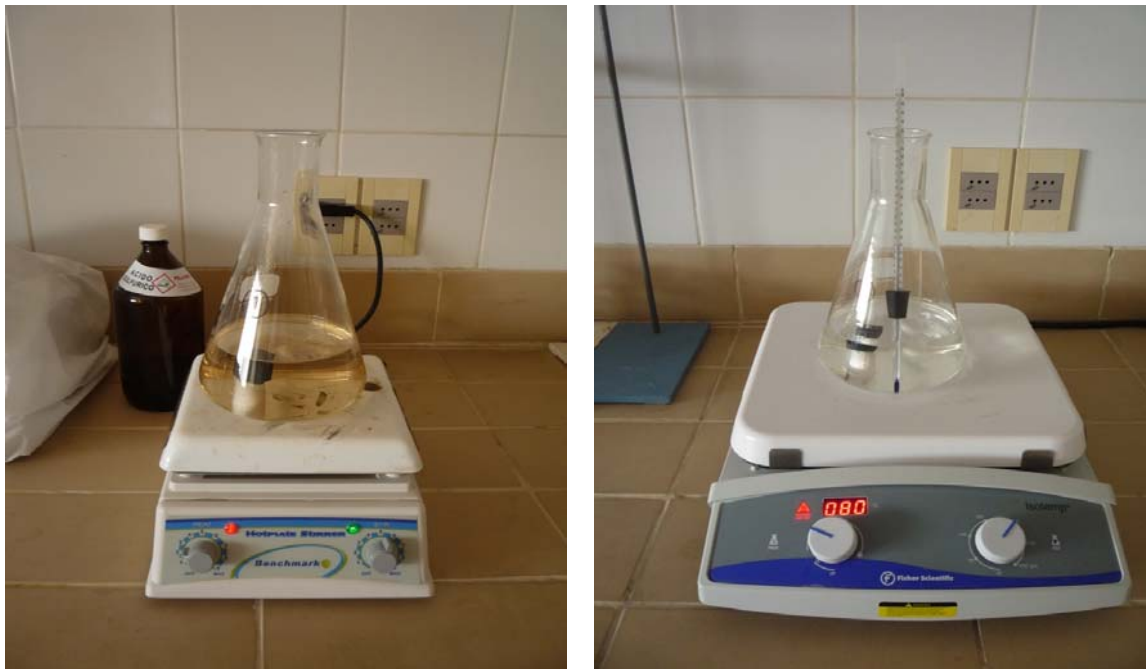
Ilustración 4 - Ensayo de laboratorio para determinación de pérdida de peso de las probetas.
