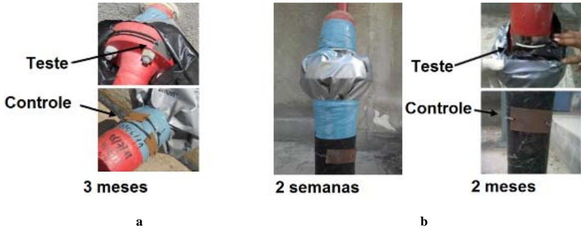
Figura 14 – Corpos de Prova Experimentais: a) Marrocos; b) Índia
