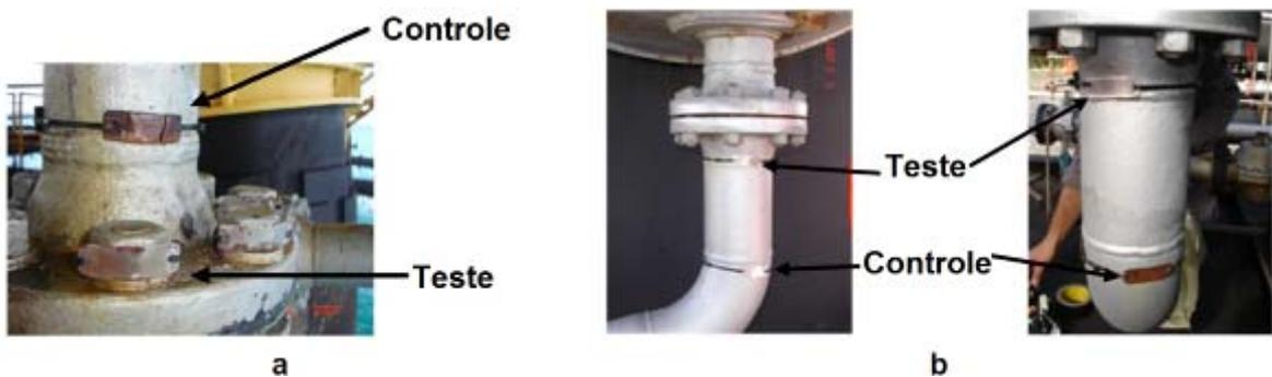
Figura 10 – Corpos de Prova Experimentais no Brasil: a) *Offshore* - 11 meses; b) Litoral - Início do teste (esquerda), após 5 meses (direita)
