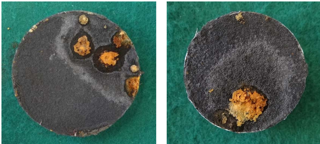
Figura 12 - Corpos de prova sem proteção catódica e com corrosão localizada, após 180 dias de ensaio.
