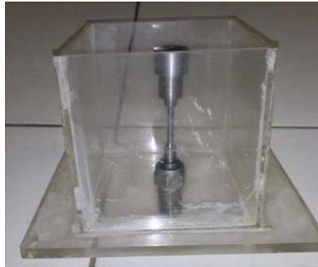
**Figura 2- Montagem da célula de proteção catódica na máquina de ensaios.**
