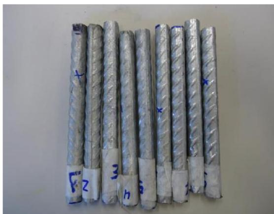
**Figura 5 – Vergalhões galvanizados (bitola 10 mm) antes do ensaio**
