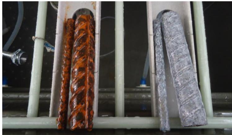
**Figura 7 – Barras de aço comum (direita) e galvanizadas (esquerda) após o ensaio de 672 horas de exposição em câmara salina para diâmetros de 10 mm e de 25 mm.**
