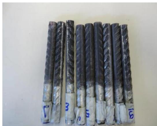
**Figura 6 – Vergalhões galvanizados (bitola 10 mm) após 06 ciclos de imersão em solução de Cobre – Não apresentou depósito**
